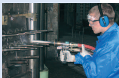
Nettoyage de moules chauds
